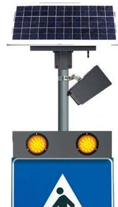
Da unser System mit Funkverbindung arbeitet und daher keinerlei Kabelverlegungen in der Fahrbahn erfordert, ist die Anlage schnell einsatzbereit. Die Erfassung jener Personen, die den Schutzweg queren wollen erfolgt mit speziellen IR-/ Mikrowellensensoren, die so konstruiert sind, dass nur ein schmaler aber absolut notwendiger Bereich erfasst wird > > > > Dadurch wird die Auslösung durch Fahrzeuge und normale Gehwegbenutzer weitgehend unterbunden.
